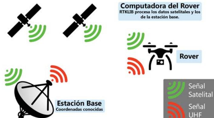
Figura 2. Corrección RTK.
