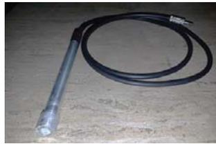
Fig. 5. Transductor ultrasónico con capa de Rexolite.
