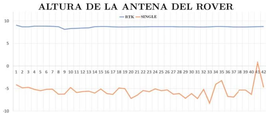
**Figura 4.** Comparación de medición de altitud (altitud de la antena del Rover) en cada segmento muestreado.
